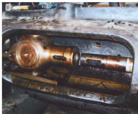
Links das Kreuzkopflager und rechts die Kolbenstange nach der Trennung.
