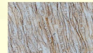
Das Dünnschliffbild zeigt die Struktur des einstigen Holzes, welche durch die rechtzeitige Verkieselung erhaltene geblieben ist. Höhe des Bildausschnittes ca. 0,5 mm
