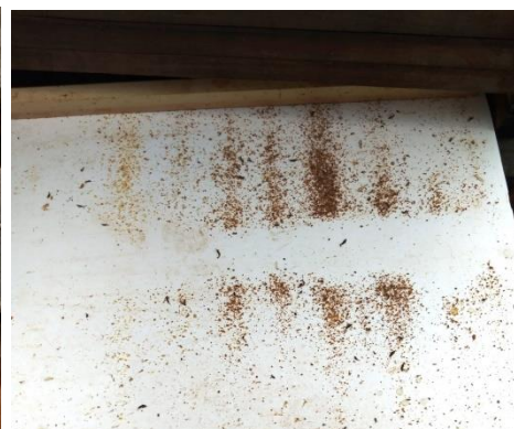
Schieber unter dem Lüftungsgitter zur Sammlung des Gemülls (links nach 2 Wochen im November, rechts nach 8 Wochen)
